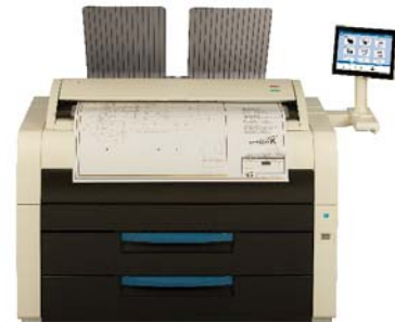
KIP 7980 Sistema di stampa multi-funzione con scanner CIS e vassoio raccogli stampe frontale integrato
